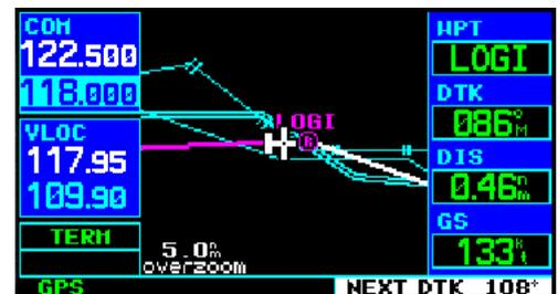
Nun wird der Flight Plan auf der Moving Map als violette Linie angezeigt, bzw. werden in der *Default-NAV* Seite die entsprechenden Informationen angezeigt. Bei Annäherung an den nächsten Waypoint wird rechts unten am Display der Desired Track (DTK) angezeigt, welcher auch am analogen CDI eingestellt werden kann, dieses zeigt dann ebenfalls die Ablage an.
